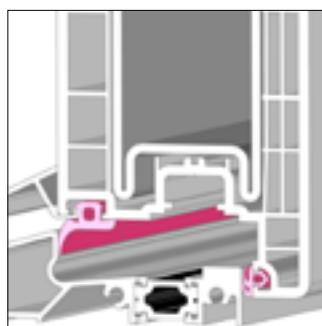
**Два контура уплотнений в области порога**
