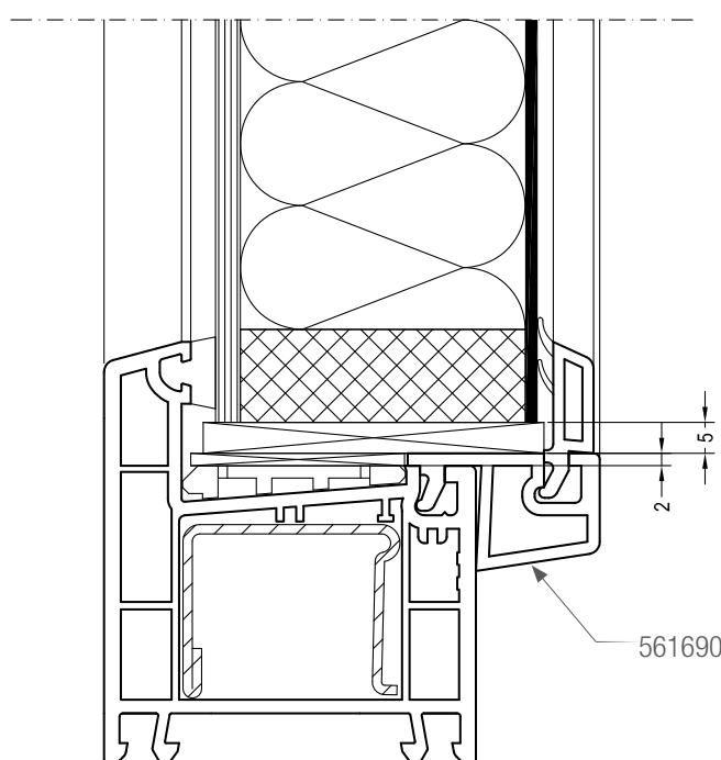
Заполнения толщиной 30-55 мм могут быть установлены с использованием расширителя фальца остекления арт. 561690.
